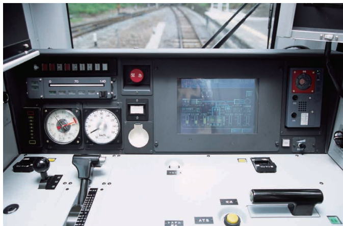
キハE200形の運転台。正面のモニター装置に、ハイブリッドシステムの電気の流れと充電量が表示されており、しくみと電気の流れがよくわかるようになっている。
